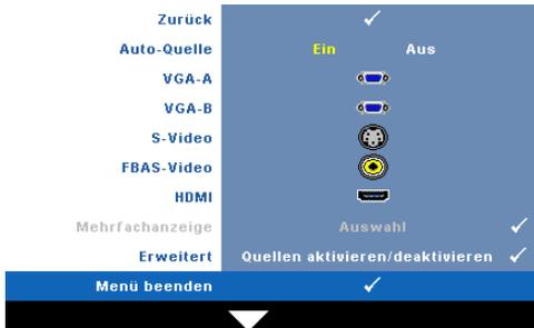
**AUTO-QUELLE**—Wählen Sie **Aus** (Standardauswahl), um das aktuelle Eingangssignal zu speichern. Wenn Sie die **Quelle**-Taste betätigen, während **Auto-Quelle** auf **Aus** eingestellt ist, können Sie das Eingangssignal manuell auswählen. Wählen Sie **Ein** zur automatischen Erkennung verfügbarer Eingangssignale. Wenn Sie bei aktivierter **Auto-Quelle** die **Quelle**-
